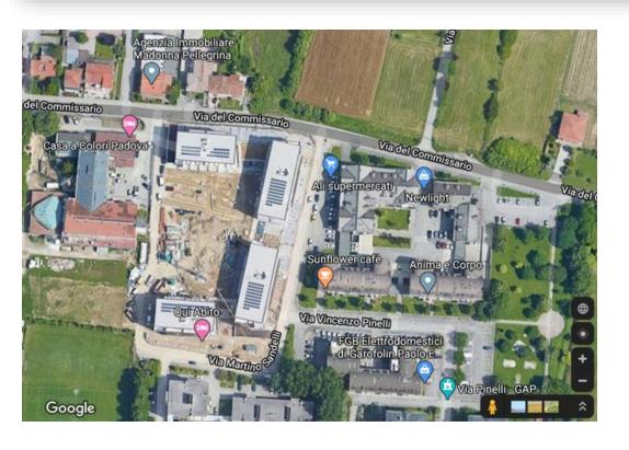
In copertura di ciascun edificio sono presenti anche impianti fotovoltaici a servizio degli usi condominiali. Le potenze sono di circa 10-12 kWp per edificio. La potenza totale fotovoltaica installata attualmente è di circa 45 kW.
